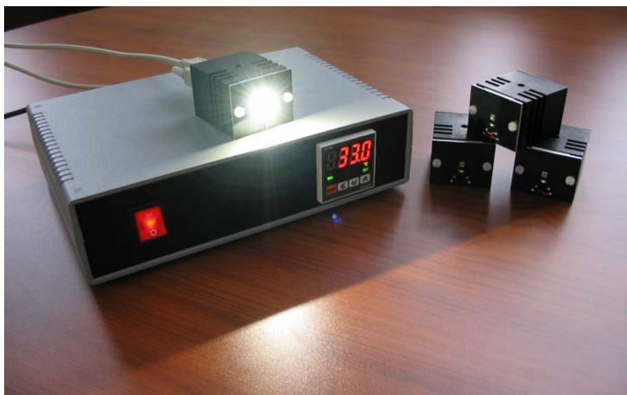
Рисунок 3. Образцовый источник излучения и светоголовка (справа).
